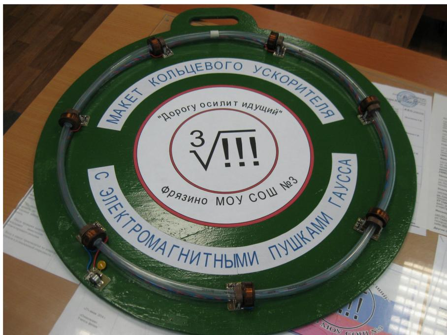
Макет кольцевого ускорителя с электромагнитными пушками Гаусса Татьяны Шемшур
